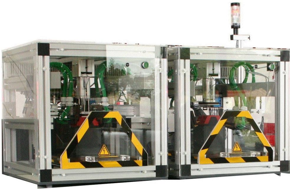
Pneumatische Haube mit Schublade (Tandemausführung)
