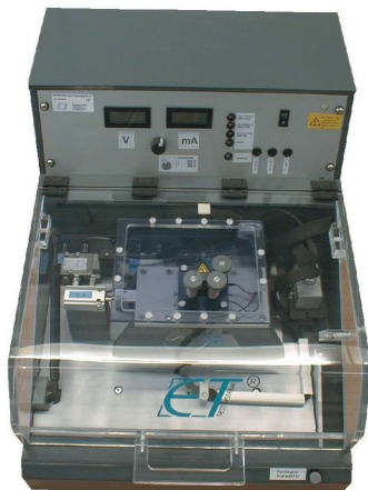
Prüfhauben in verschiedenen Ausführungen mit Prüflingsadapter
